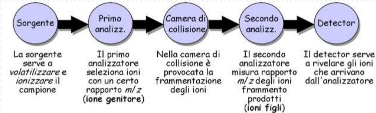
Uno spettrometro di massa tandem ha due analizzatori, e una camera di collisione.
