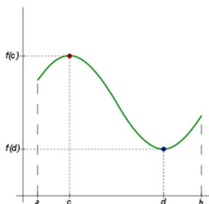
Fig. 1 Esempio di funzione continua nell'intervallo  $[a, b]$  che ammette un massimo e un minimo, rispettivamente in  $c$  e in  $d$
