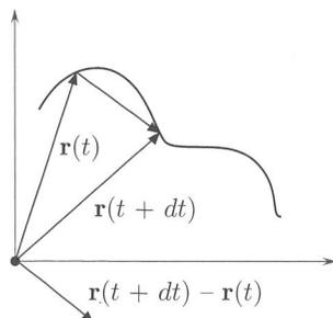
Figura 7.10. Per  $dt \rightarrow 0$  il vettore  $\frac{\mathbf{r}(t+dt) - \mathbf{r}(t)}{dt}$  tende a una posizione limite, tangente alla linea in  $\mathbf{r}(t)$ .
