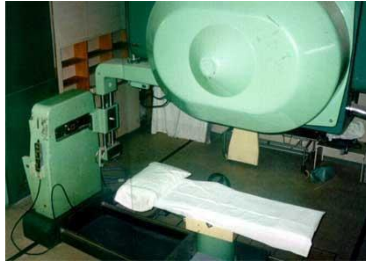
Asklepitron: betatrone da 31 MeV della Brown Boveri installato presso l'ospedale di Firenze dal 1960 al 1993
