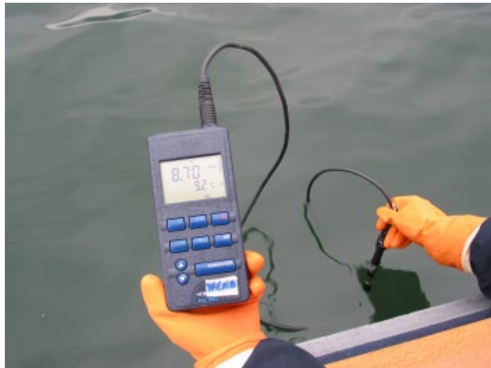
Prova di misura con ossimetro
