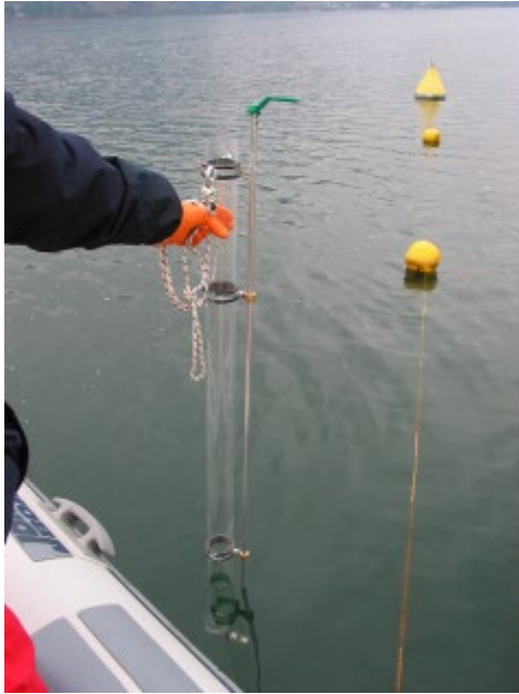
Prelievo di un campione d'acqua ad una profondità assegnata.
