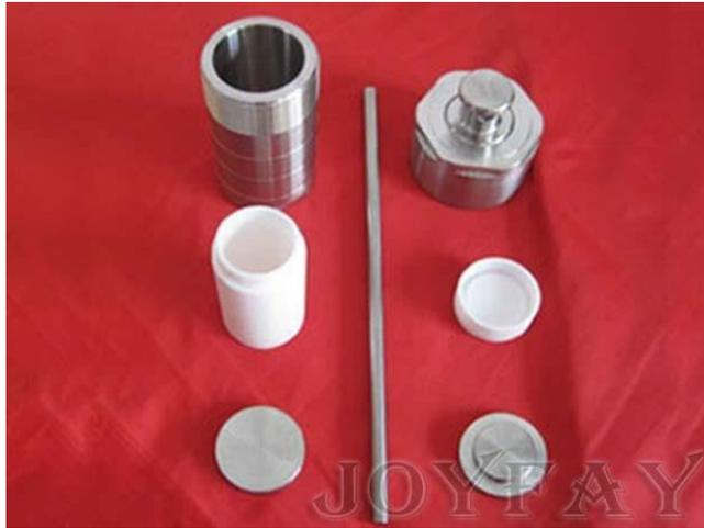
➤ Sintesi: i precursori di Cu, Sn, Mn o Fe e S (acetati, cloruri e tiourea) in glicole etilenico sono sigillati in autoclave e mantenuti a circa 200 °C per 10-15 h.
