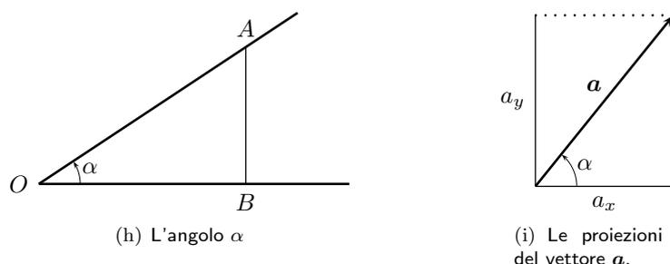
**Figura C.1:** Definizione e uso delle funzioni goniometriche.
