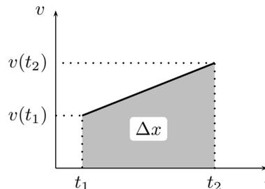
**Figura 1.3:** Lo spostamento del moto uniformemente accelerato.
