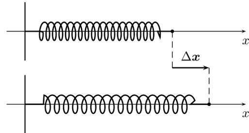
**Figura 2.4:** La deformazione della molla.
