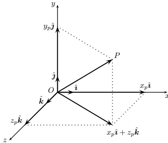
**Figura 1.6:** Rappresentazione con vettori di un vettore tridimensionale
