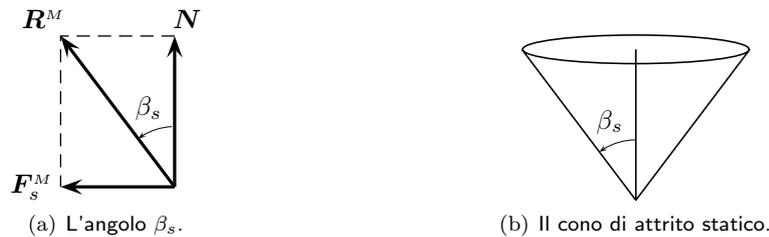
Figura 2.2: La reazione vincolare nel caso di una superficie scabra.
