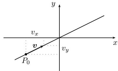
Le componenti della velocità sono costanti, quindi il moto è scomponibile in due moti rettilinei ed uniformi; uno lungo l'asse delle ascisse con velocità  $v_x$  e uno lungo l'asse delle ordinate con velocità  $v_y$ . Le posizioni occupate da  $P$  per diversi valori di  $t$  sono quindi quelle aventi coordinate date dalle
