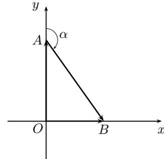
Come si deduce dalla figura, il moto di  $B$  rispetto ad  $A$  è un moto rettilineo uniforme di avente la direzione ed il verso del vettore  $AB$ ; questa direzione forma con il nord un angolo  $\alpha$  tale che sia
