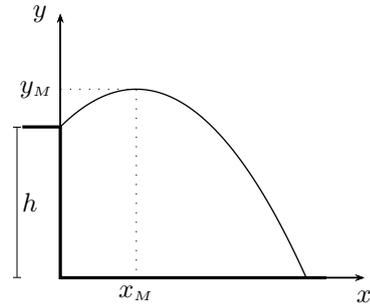
L'altezza massima raggiunta si ha nell'istante  $t_1$  in cui la velocità è orizzontale, cioè in cui  $v_y = 0$ ; ciò si verifica per
