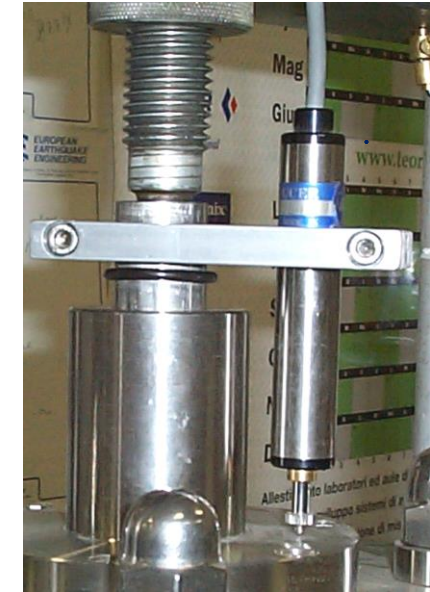
Figura 1. Funzionamento schematico di un trasduttore di posizione: l'elemento mobile, spostandosi in base alla grandezza di ingresso, determina la variazione della tensione in uscita al morsetto C.
