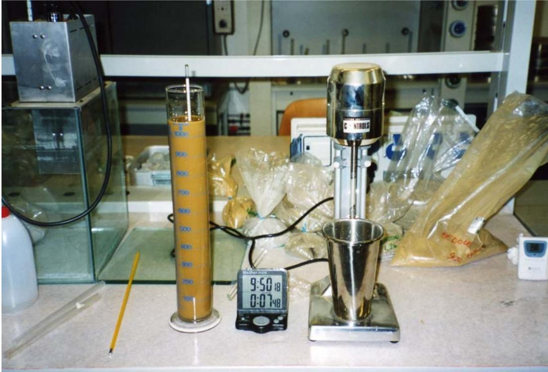
**Figura 3.5 : agitatore per la dispersione della soluzione con cilindro sedimentatore, cronometro e termometro a bulbo**
