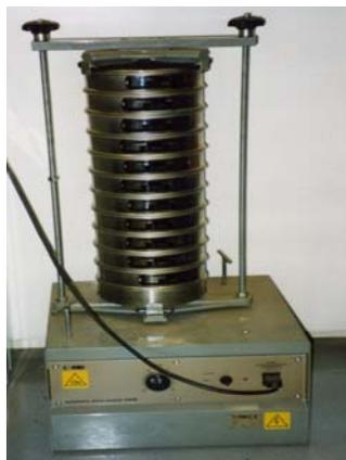
**Figura 3.2 :** piastra vibrante Controls per la vagliatura del terreno tramite setacci
