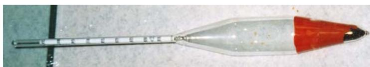
Figura 3.3 : densimetro Controls tipo ASTM 151H adottato per l’analisi per sedimentazione
